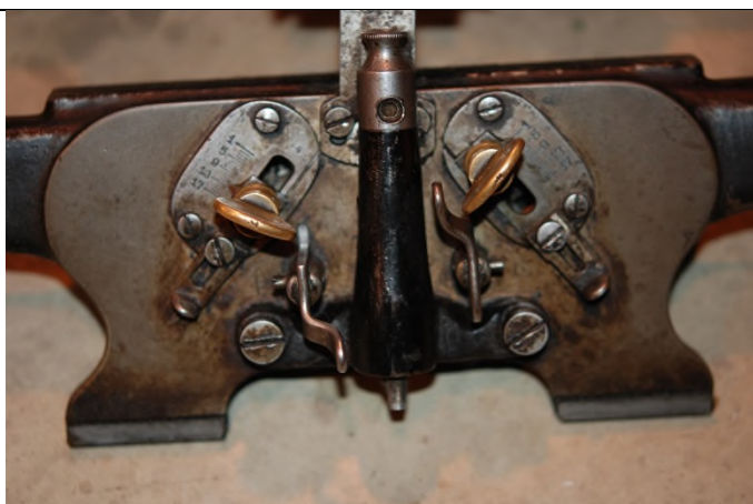
JÆG2006.06.165_15 Bakre sledehalvdel innstilt til rundstrikk. Siden med tapp og skrue opp må være på motsatt side av den fremre sleden for at fremre og bakre sledehalvdel skal strikke hver sin vei. Fremgår ikke av bildet slik det er tatt.
