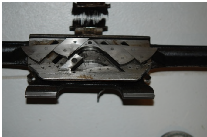
JÆG2006.06.165_14 Undersiden av fremre sledehalvdel ved rundstrikk
