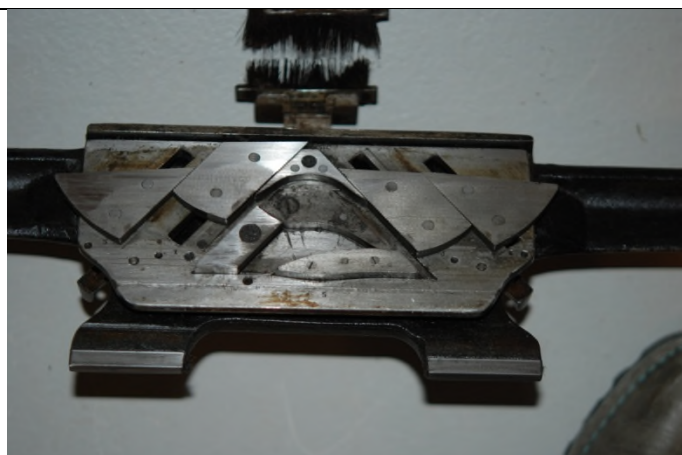
JÆG2006.06.165_18 Undersiden av fremre sledehalvdel ved patentstrikk
