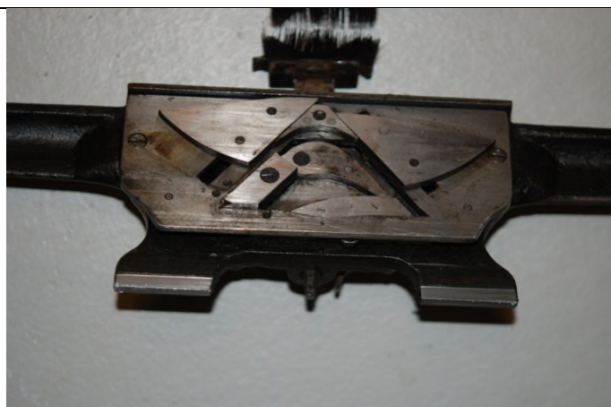
JÆG2006.06.165_16 Undersiden av bakre sledehalvdel ved rundstrikk
