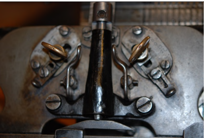
JÆG2006.06.165_11 Bakre sledehalvdel innstilt til vanlig strikk
