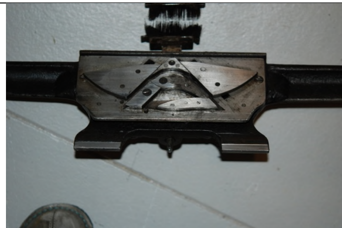
JÆG2006.06.165_12 Undersiden av bakre sledehalvdel ved vanlig strikk
