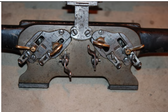
JÆG2006.06.165_13 Fremre sledehalvdel innstilt til rundstrikk
